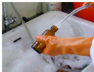
(2) ล้างด้วยน้ำประปา
