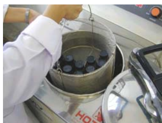
(4) นำไปอบฆ่าเชื้อที่อุณหภูมิ 170 °C
