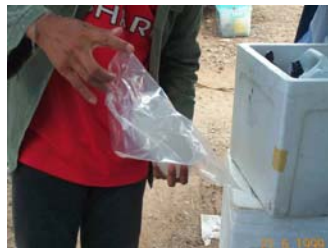
(1-2) นำขวดตัวอย่างน้ำมาบรรจุในถุงพลาสติกอีกครึ่งเพื่อป้องกันการปนเปื้อนจากภายนอก
