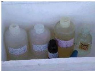
(1-2) นำขวดตัวอย่างน้ำมาบรรจุในถุงพลาสติกอีกครึ่งเพื่อป้องกันการปนเปื้อนจากภายนอก
